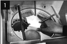
メックを取り付ける際には、ド ラムの穴と本体の穴の位置を合 わせて下さい。(右図参照)
