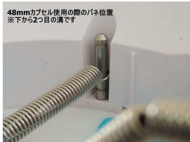
③48mmのカプセル用のバネ位置 下から2つめの溝に引っ掛けています
