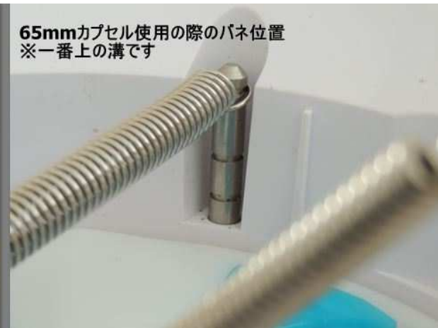
④65mmのカプセル用のバネ位置 一番上の溝に引っ掛けています
