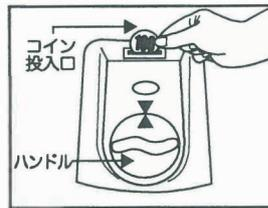
▼印の位置にハンドルの▲印を合わせ 100 円硬貨 (又は専用コイン) を投入します。
