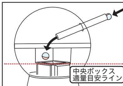
ドーム上部背面の穴に付属のカプセル投入用筒を差し込みます。筒の後方よりカプセルを1つずつ転がし入れます。
