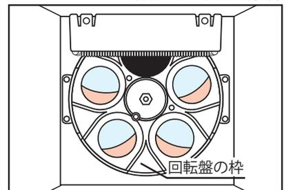
中央カプセルボックスにカプセルを補充する際には、回転盤の枠それぞれ4つにカプセルが入っているか確認してから補充を行ってください。
