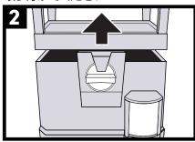
天蓋が外れたら、カプセルケースを 持ち上げ、そのまま上に引き抜きま す。
