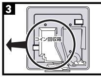
マシン内部の白いコイン回収箱を取り外します。
