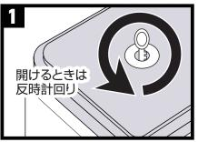
ガチャコップ L の天蓋にカギを差し 込み、反時計回りに天蓋が外れるま で回します。
