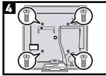
ガチャコップ L とスタンドをを固定するため、上図の4カ所に付属のネジを取り付けます。※1参照
