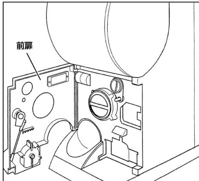
②カプセルケースストッパーを両サイドから内側へ向かって押し、ストッパーを解除します。
