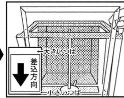
2つのパネルを入れ替えます。（この際透明な方のパネルはツバの小さい方を下にして下さい。）
