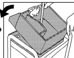
ネジでの固定が終わったら、ハカマを底板に取り付け、元に戻します。※外す時、後ろから持ち上げたように今回も後ろから取り付けて下さい。正面から取り付けるとずれる可能性があります。
