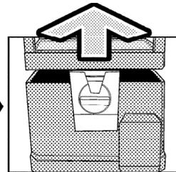
天板が外れたらカプセルケースを持ち上げ、そのまま上に引き抜きます。
