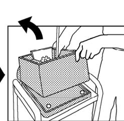
カプセルケースを外したらハカマを後ろから持ち上げ、底板から外します。※正面から持ち上げますと外れない可能性があります。必ずマシン後部から持ち上げ底板から外して下さい
