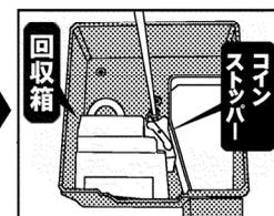
マシン内部のコイン回収箱、コインストッパーがずれていないか確認します。
