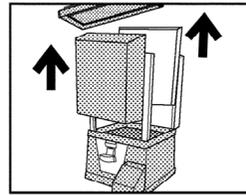
梱包時の形のまま水平な場所に置き、前部と背部のパネルを引き抜きます
