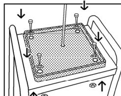
底板を専用台のネジ穴に合わせセット（ネジで固定）します。この際1穴に対し、ネジ、ワッシャー、ナットの3点を使い固定して下さい。
