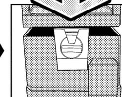
コインメック、コインケースを元に戻し、取り外していたカプセルケースも元に戻します。
